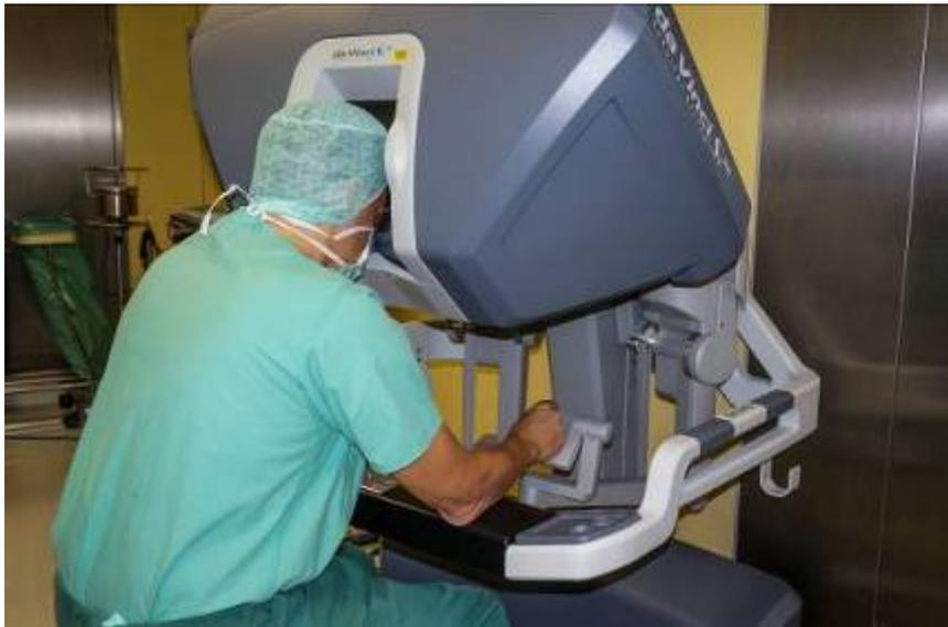
**Die Arbeitskonsole des „da Vinci®-Systems“ ermöglicht es dem Operateur, bisher kaum wahrnehmbare Details zu erkennen.**
